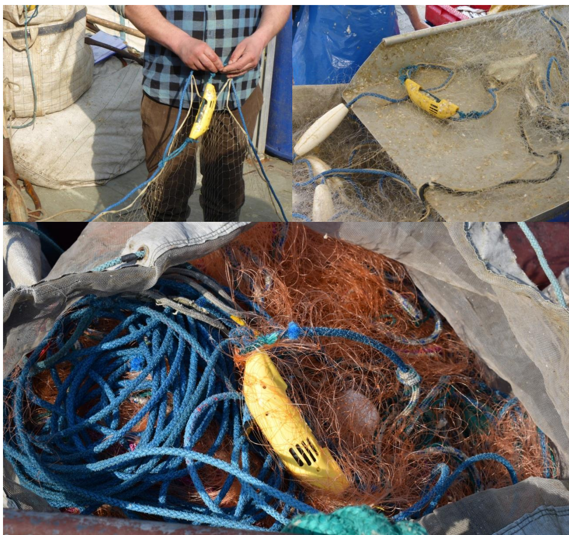
Rys.14 Akustyczne urządzenia ostrzegawcze (pingery) zamontowane na sieciach skrzelowych.
