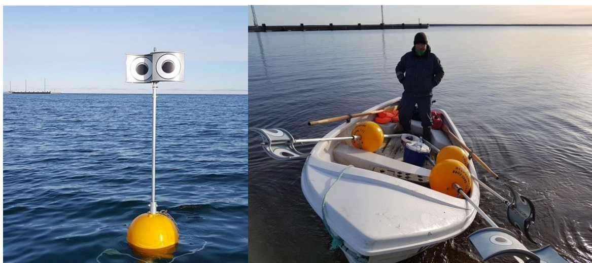
Rys.17 Boje płoszące ptaki morskie testowane w rejonie Zatoki Küdema w Estonii 2 .
