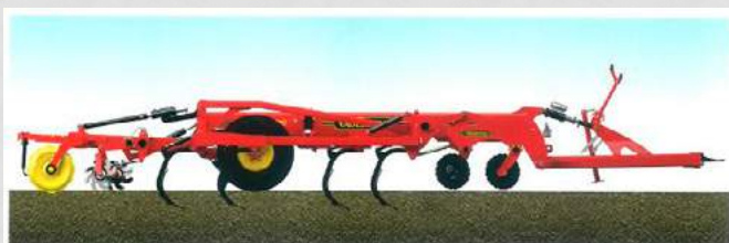
Klasyczny kultywator – pracują zęby i wał.
