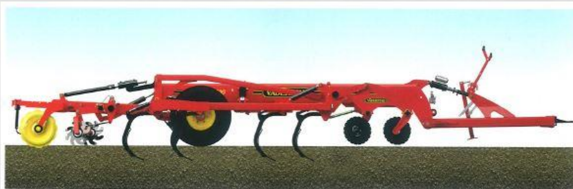
Klasyczny kultywator – pracują zęby i wał.
