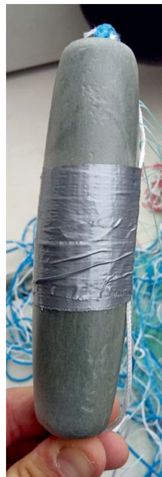
Rys. 4.7. Znacznik umieszczony w pływaku piankowym (Instytut Logistyki i Magazynowania w Poznaniu)
