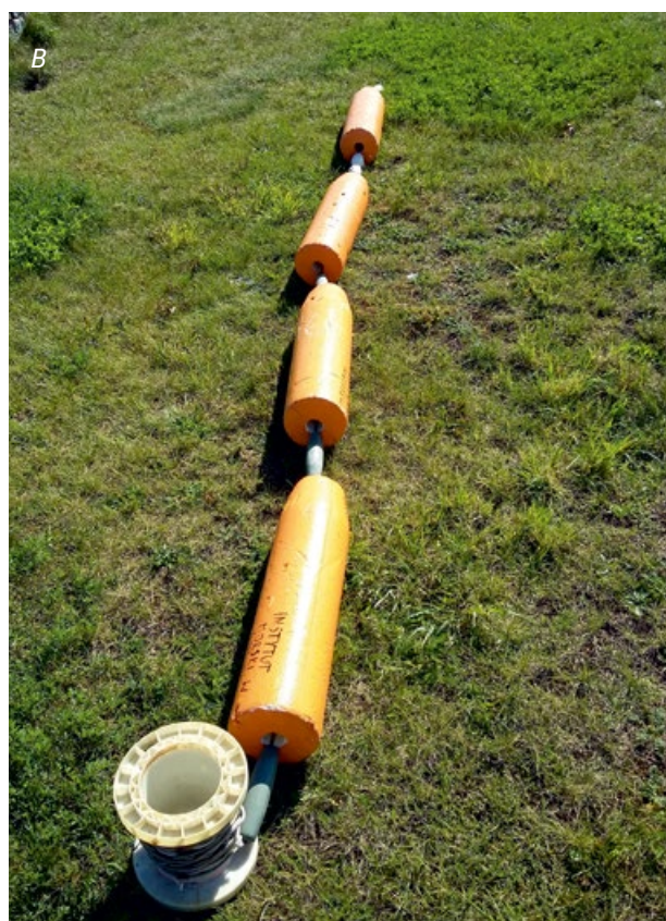
Rys. 4.9A-B. Testowany zestaw pływaków ze znacznikami RFID z większą anteną (Instytut Morski w Gdańsku)
