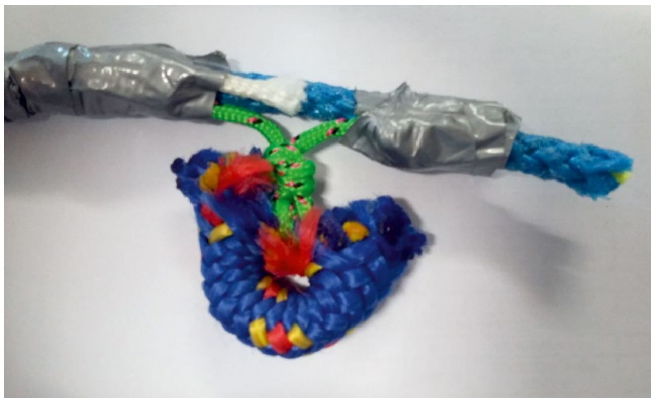
Rys. 4.8. Przywiązany do sieci oplót linki z umieszczonym wewnątrz znacznikiem (Instytut Logistyki i Magazynowania w Poznaniu)
