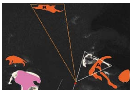
Rys. 1. Usytuowanie łąch w roku 2010 (oryginalny /biały/ kolor na fotografii) i ich lokalizacja w maju 2011 roku (kolor pomarańczowy). Czerwonym punktem zaznaczono miejsce usytuowania punktu wideoobserwacji. Sektor obserwacji „Mewia Łacha” (A) i sektor obserwacji „Focza Łacha” (B) (Rys. GBPW KULING)
