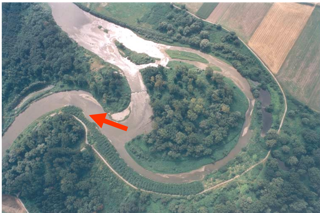
Ryc. 11a: Uszkodzenie polskiego brzegu przy ujściu nowego koryta rzeki w przerwanym meandrze – wygląd ogólny- sierpień 2002 (Foto: P. Novotný, Ostrava)
